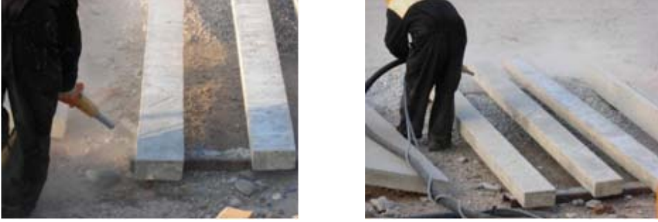
Şekil 2. Kiriş numunelerine kum püskürtülerek yüzeyinin hazırlanması
